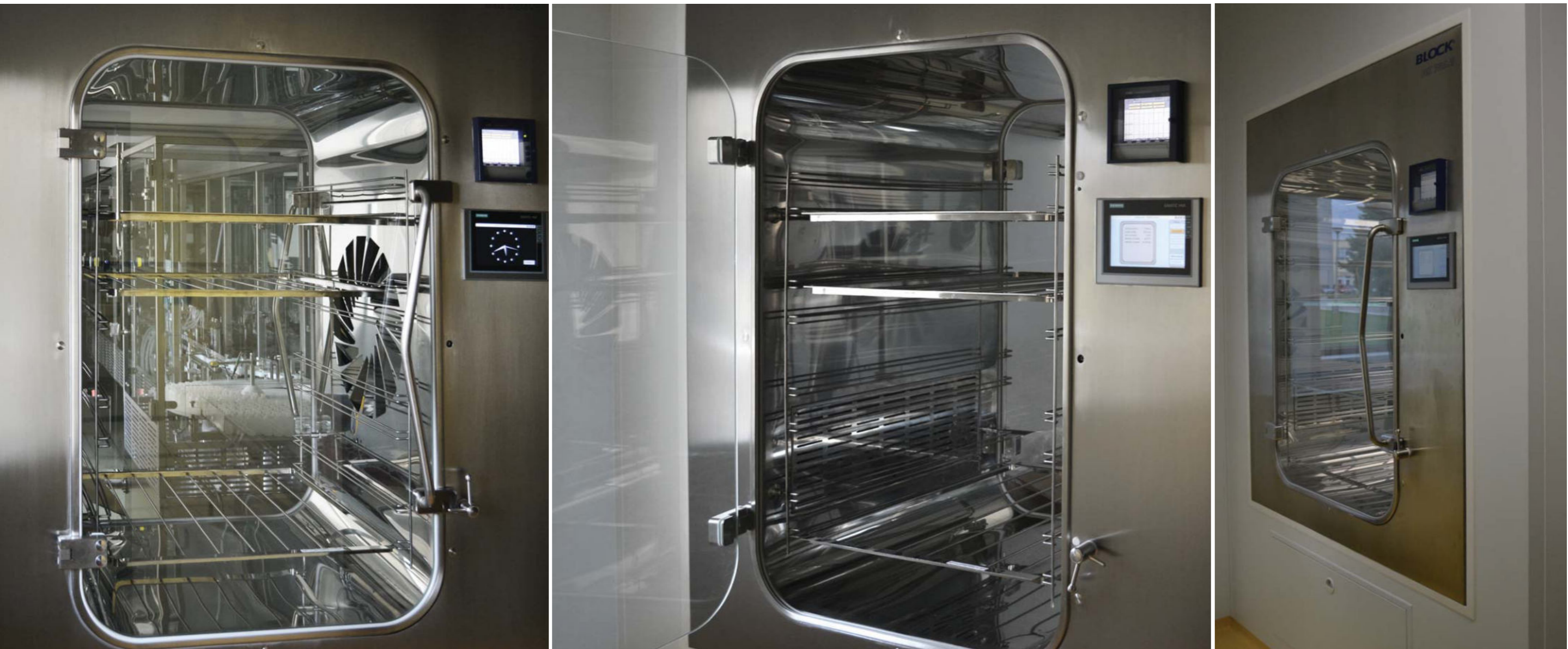
ПЕРЕДАТОЧНАЯ КАМЕРА С ЦИКЛОМ VHP (ПАРОВ ПЕРЕКИСИ ВОДОРОДА)
